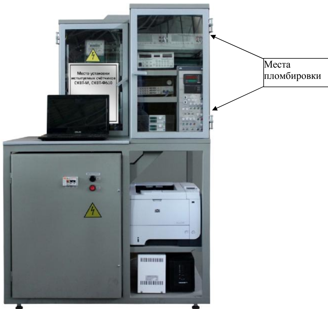
Рисунок 1 – Фотография общего вида стенов автоматизированных для поверки счетчиков электроэнергии СКВТ-Ф610, СКВТ-М. Тип А3301
