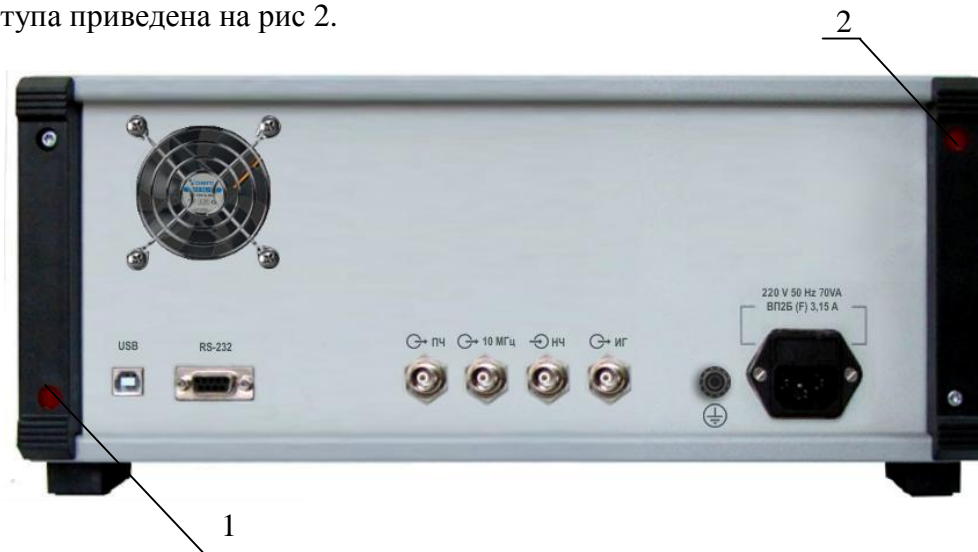
Рисунок 2 - Схема пломбирования измерителей
