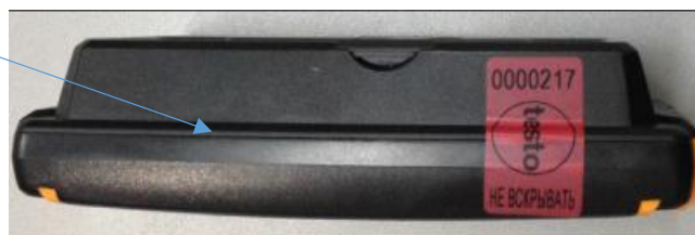
Рисунок 2 – Схема пломбировки измерительного прибора Testo 420 с датчиками с нанесением знака поверки
