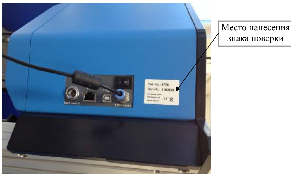
Рисунок 2 – Фотометры пропускания haze-gard i (вид сзади) с указанием места нанесения знака поверки
