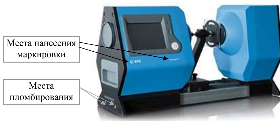
Рисунок 1 – Общий вид фотометров пропускания haze-gard i с указанием мест нанесения маркировки и пломбирования
