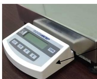
Рисунок 2 - Схема пломбирования от несанкционированного доступа
