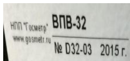
Рисунок 3 - Обозначение места нанесения знака поверки
