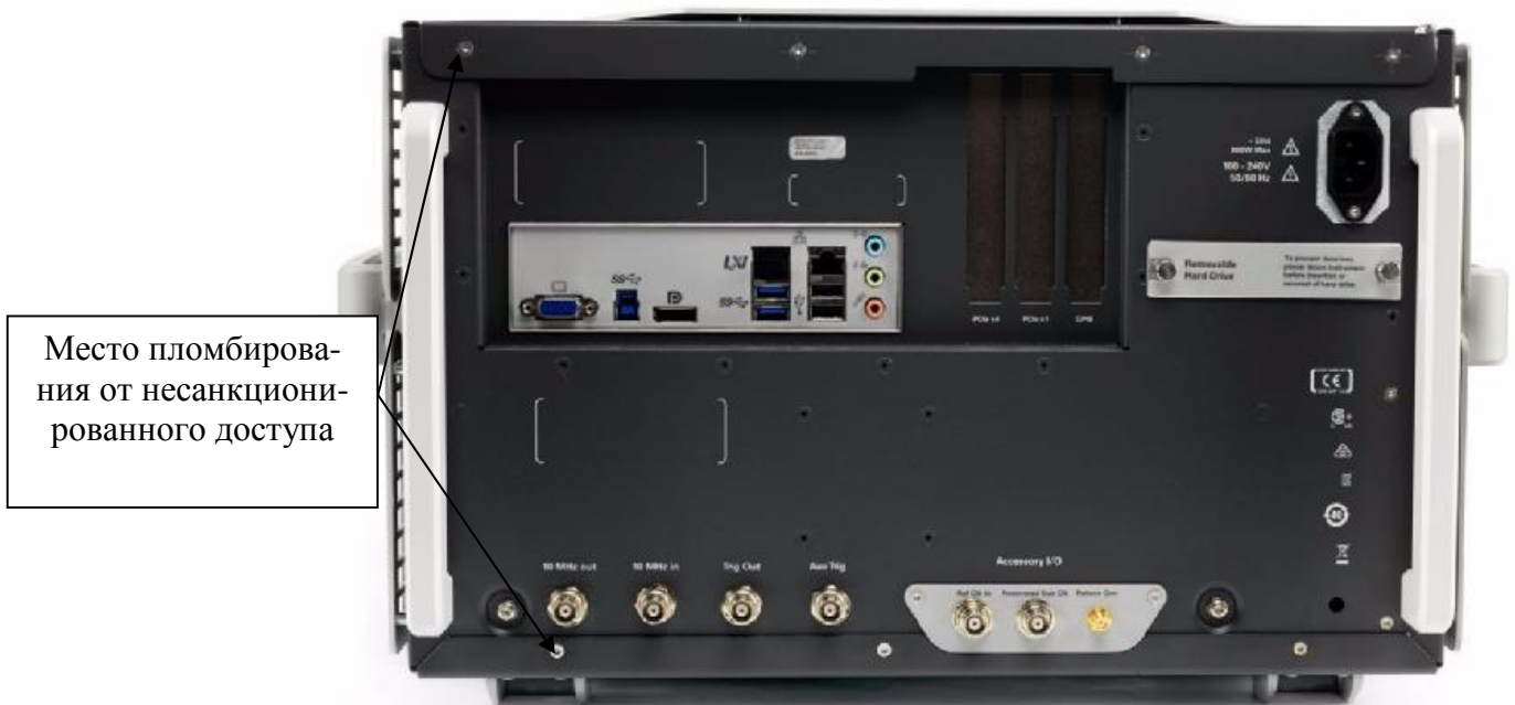
Рисунок 2 - Схема пломбировки от несанкционированного доступа
