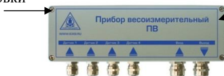
Рисунок 2 — Пример схемы пломбировки весов и общий вид УОАД
