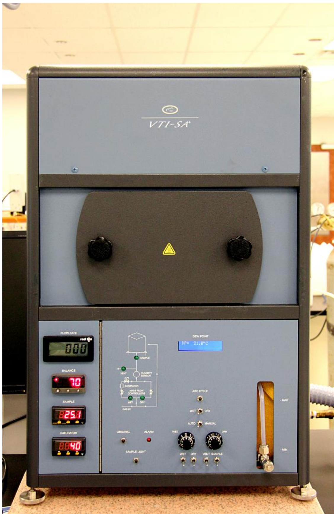
Рисунок1 - Внешний вид анализатора VTI-SA +
