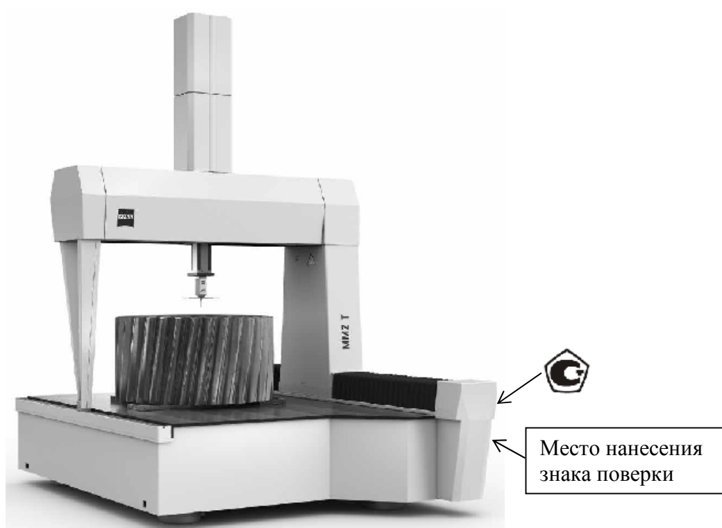
Рисунок 3 - Общий вид координатных измерительных машин MMZ T и место нанесения знака утверждения типа
