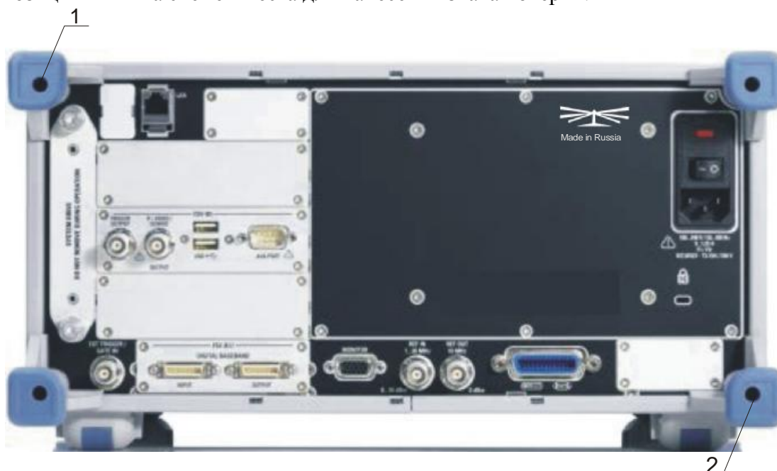
Рисунок 2 - Схема пломбирования от несанкционированного доступа с нанесением знака поверки
