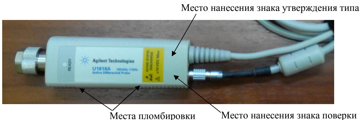
Рисунок 2 - Общий вид пробника с указанием мест пломбировки и нанесения знака утверждения типа
