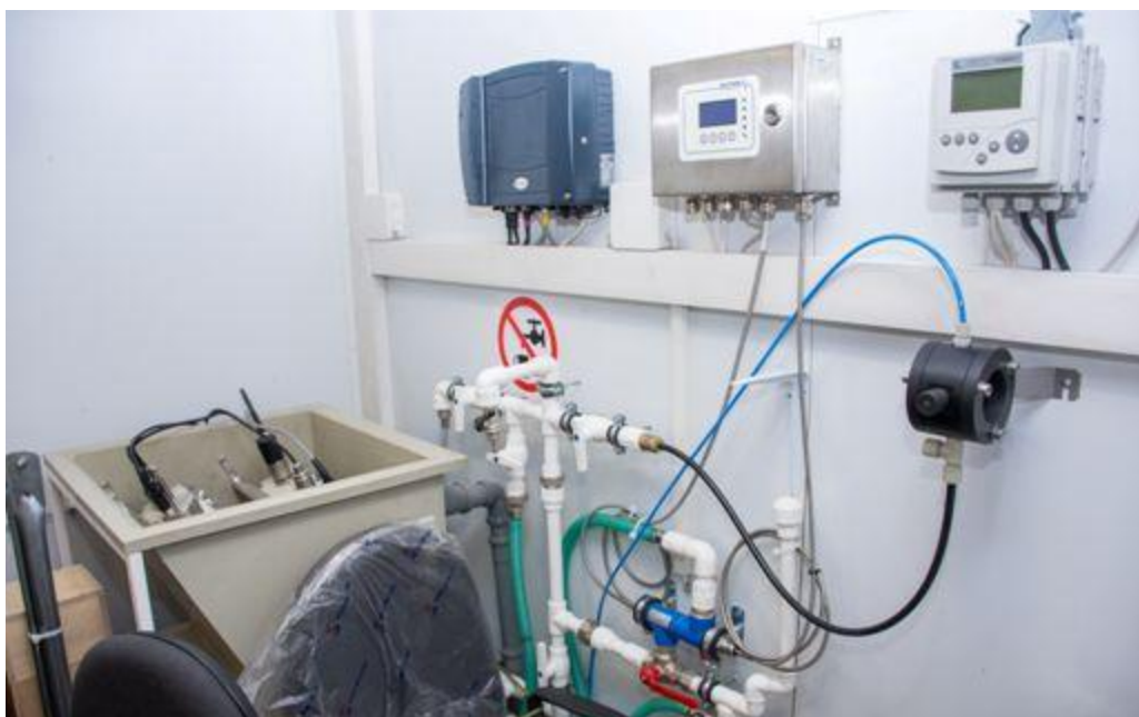
Рисунок 3 - Вид станции АСК-В в передвижном исполнении на базе автоприцепа
