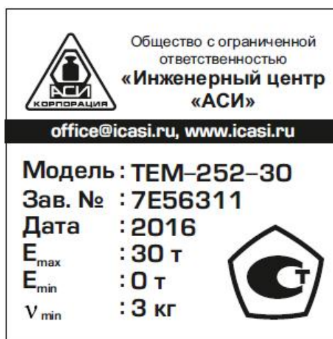
Рисунок 2 - Маркировочная табличка датчика весоизмерительного тензорезисторного TEM-252
