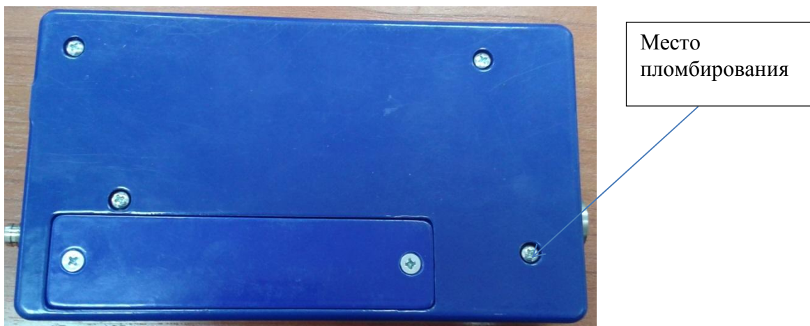
Рисунок 2 - Задняя сторона измерительного блока с местом пломбирования
