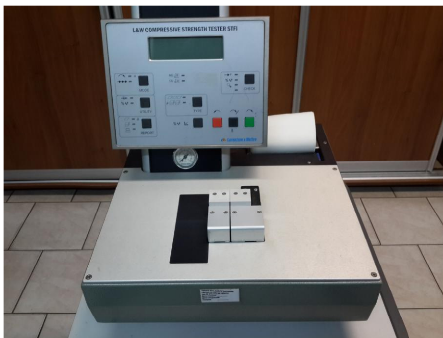
Рисунок 1 - Общий вид прибора для определения сопротивления сжатию на коротком расстоянии SE 152, зав № 214
