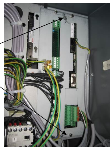
Рисунок 3 - Схемы пломбирования измерителей объема поршневых с датчиками импульсов
