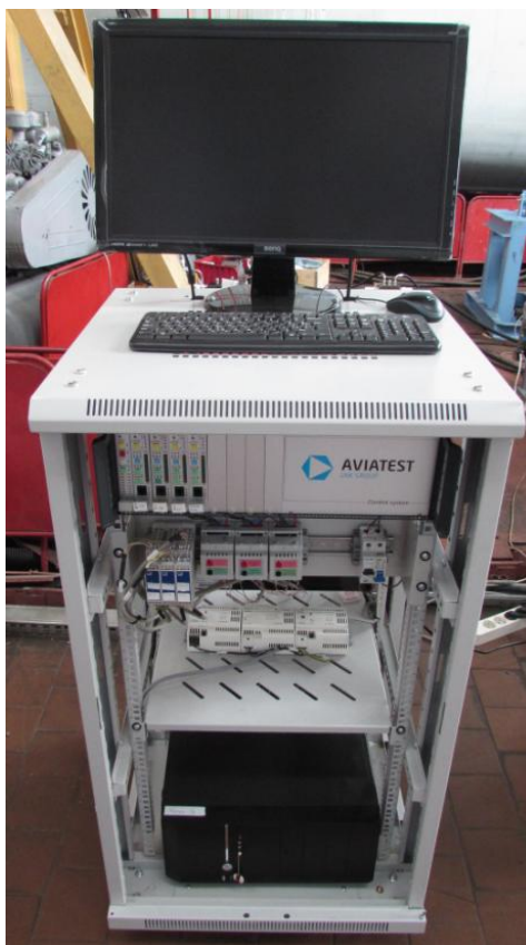
Рисунок 1 - Общий вид рабочего места оператора и СУ «АВИАТЕСТ»
