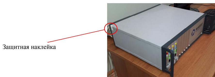
Рисунок 3 - Схема нанесения защитной наклейки от несанкционированного доступа
