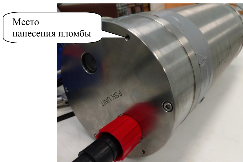
Рисунок 2 - Схема пломбировки от несанкционированного доступа
