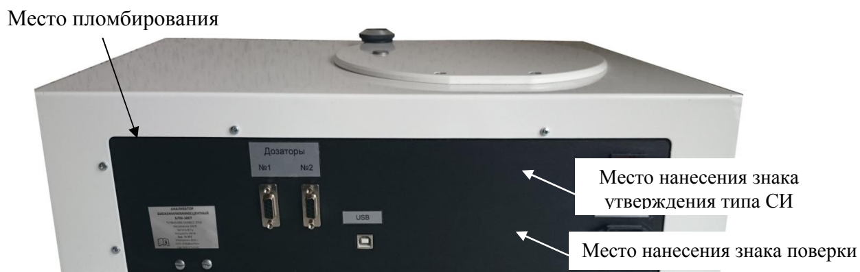
Рисунок 2 - Схема маркирования (вид сзади) и места пломбирования
