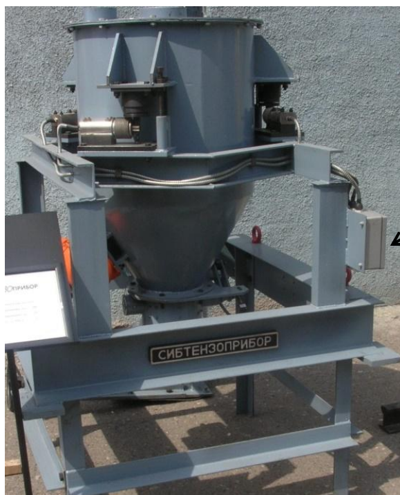
Рисунок 1 - Общий вид весов бункерных ВБ
