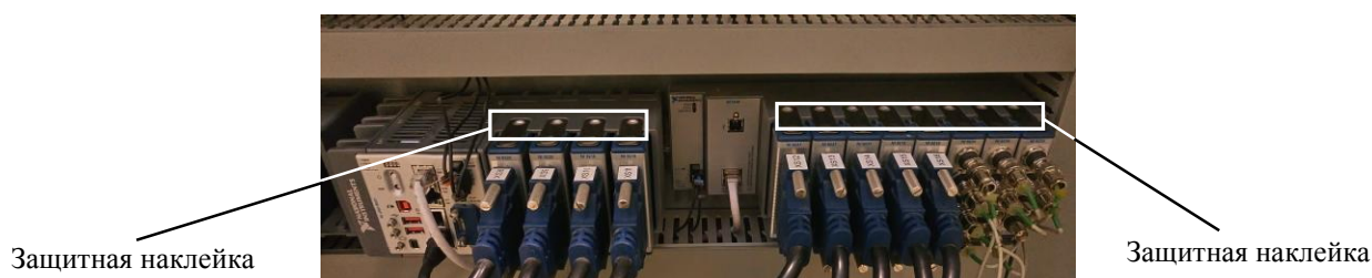
Рисунок 3 — Схема нанесения защитных наклеек от несанкционированного доступа
