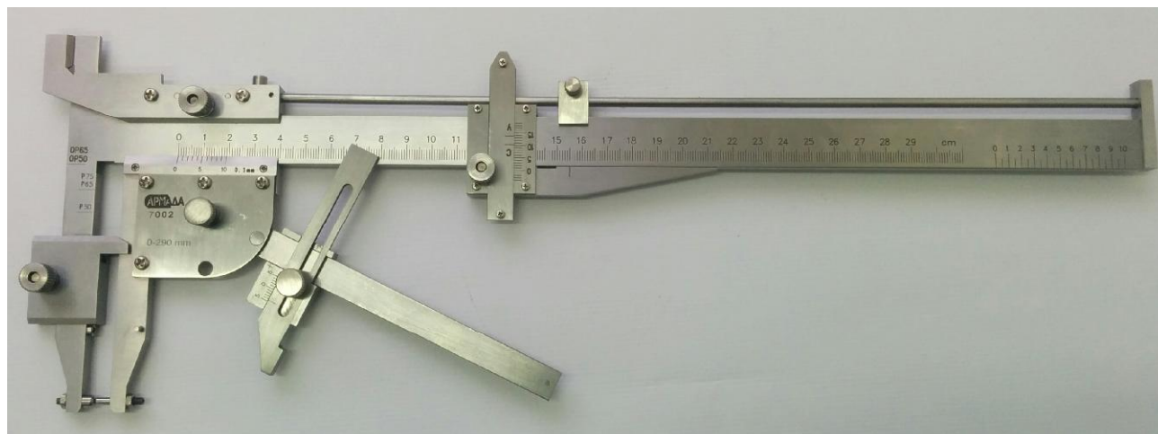
Рисунок 1 – Общий вид штангенциркуля путевого модели ПШВ-01
