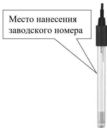
д) Общий вид датчика рН/ОВП 201022, 201027
