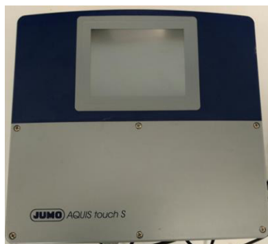
в) Вторичный преобразователь анализатора жидкости промышленного серии AQUIS модификации AQUIS touch S
