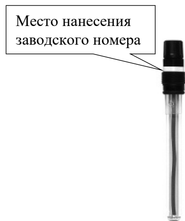
в) Общий вид датчика ОВП 201025
