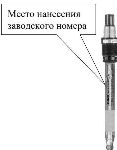
д) Общий вид датчика рН/ОВП 201022, 201027
