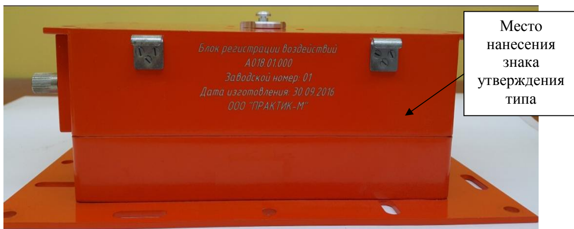
Рисунок 2 – Маркировочная табличка блока регистрации воздействий блока регистрации воздействий А018.01.000, место нанесения знака утверждения типа
