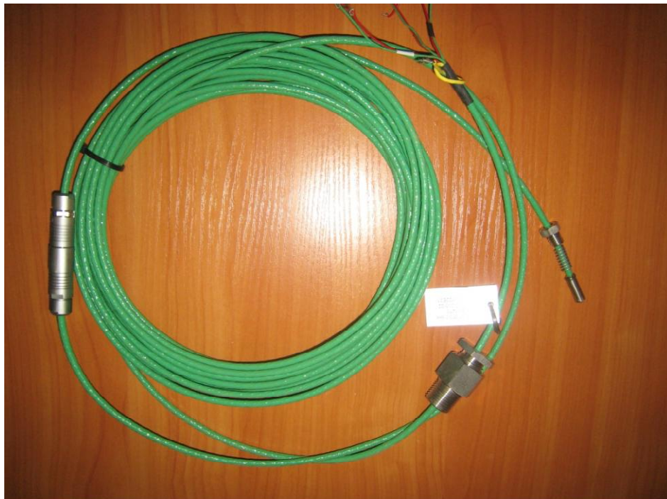
Рисунок 1 – Преобразователь термоэлектрический ТХА модели KUN 672.20
