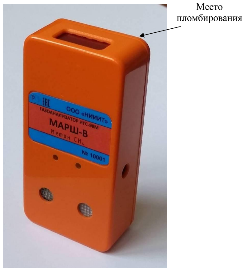
Рисунок 1 - Общий вид исполнения В (индивидуального)
