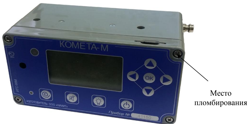
Рисунок 2 - Общий вид исполнения «Комета-М» (мультигазового переносного)
