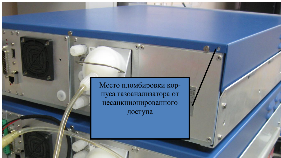
Рисунок 2 - Место пломбировки корпуса газоанализатора от несанкционированного доступа
