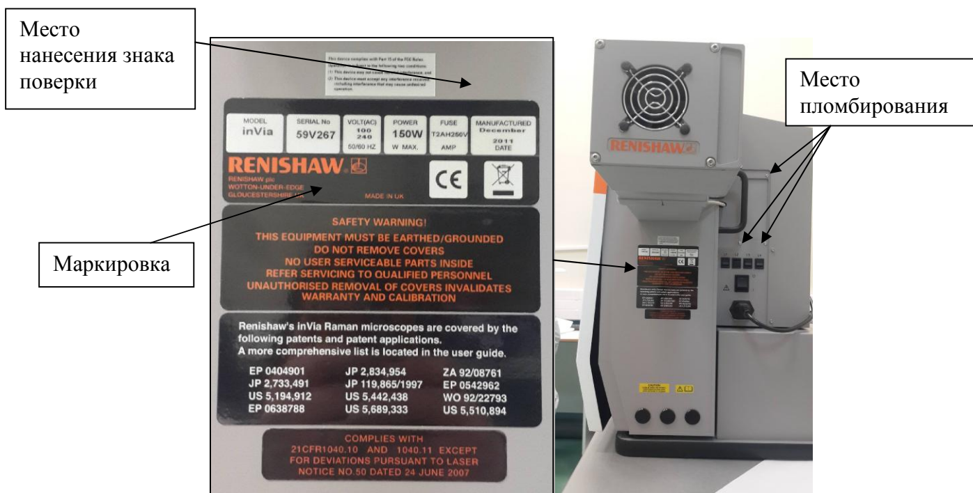
Рисунок 2 - Схема пломбировки, обозначение места нанесения знака поверки и обозначение места нанесения маркировки
