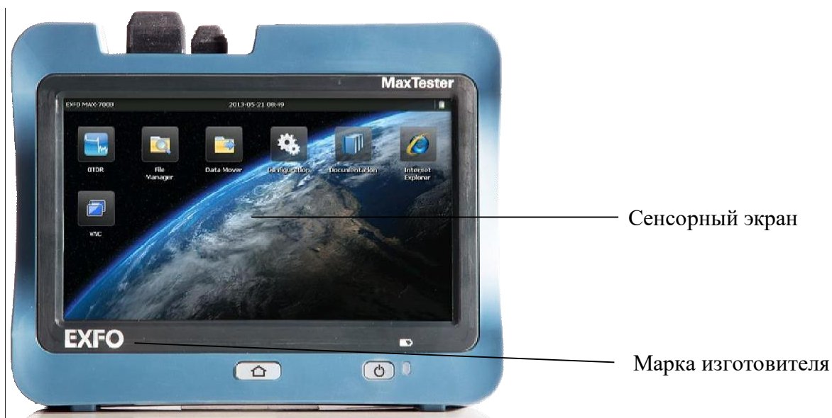
Рисунок 1 - Общий вид рефлектометров оптических серии MAX-700C
