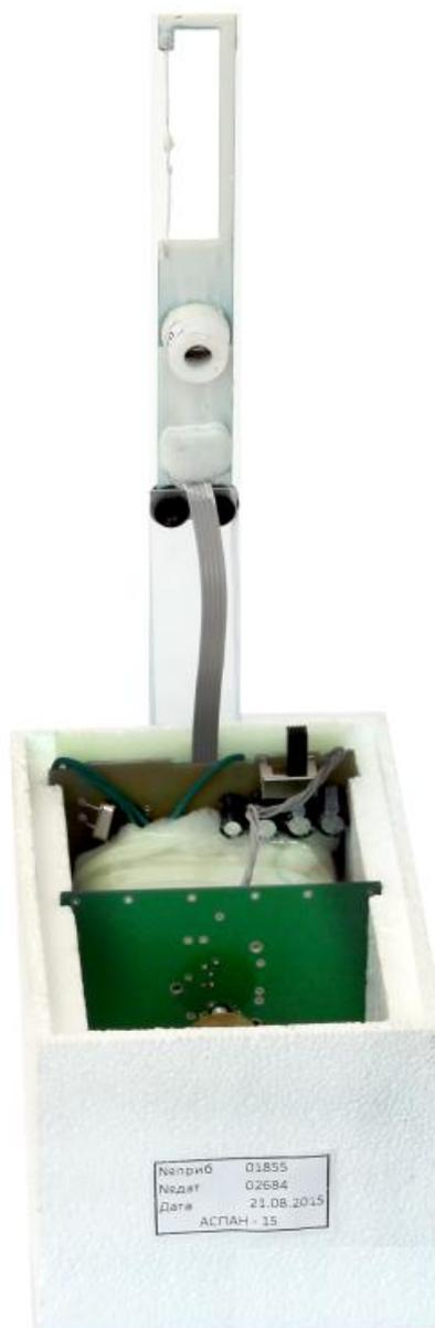
Рисунок 1 - Внешний вид радиозондов малогабаритных «Аспан-15»
