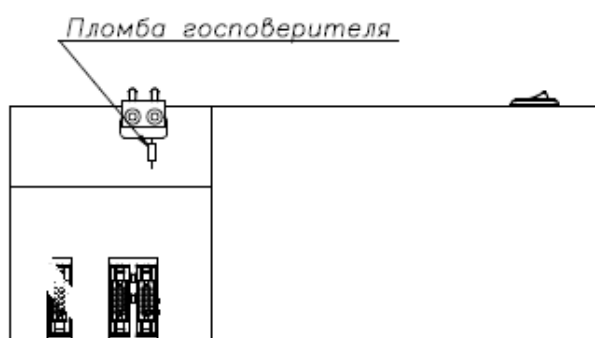
Рисунок 4 - Схема пломбировки БИУ серии «Гранит-500»
