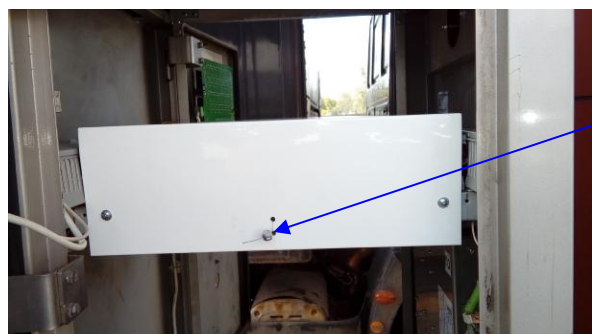
Рисунок 6 - Схема пломбировки БИУ «Штрих-ТРК»
