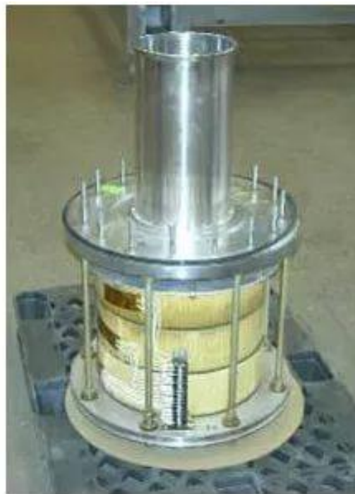
Рисунок 1 - Общий вид трансформаторов тока
