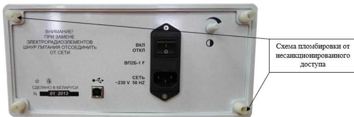
Рисунок 2 - Схема пломбировки от несанкционированного доступа
