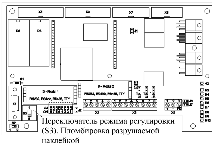
Рисунок 9 - Схема пломбировки от несанкционированного доступа средства измерений с электронным устройством, выполненным в виде микроконтроллера на печатной плате (пример)
