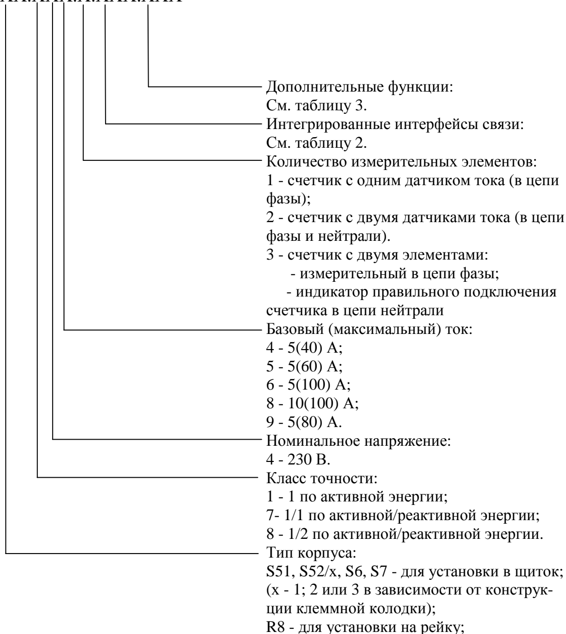
Рисунок 1 - Структура условного обозначения счетчиков
