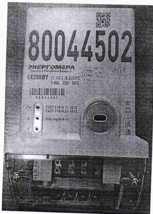
Рисунок 7 – Общий вид счетчиков CE208BY с типом корпуса С1
