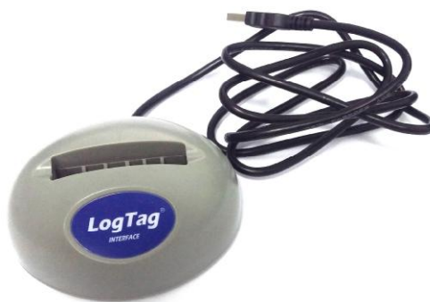
Рисунок 11 - Общий вид интерфейса связи LogTag LTI/USB тип А
