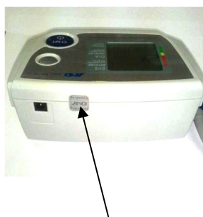
Рисунок 26 – Место нанесения защитной наклейки от несанкционированного доступа
