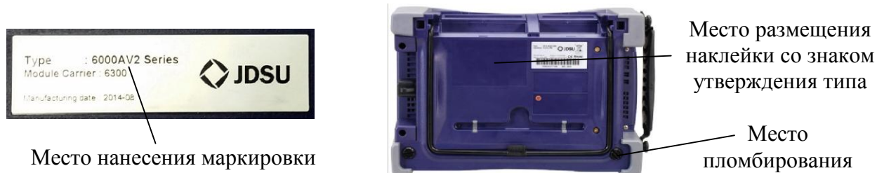
Рисунок 3 - Схема пломбировки от несанкционированного доступа, место размещения наклейки со знаком утверждения типа базового блока модификаций MTS-6000A, MTS-6000AV2
