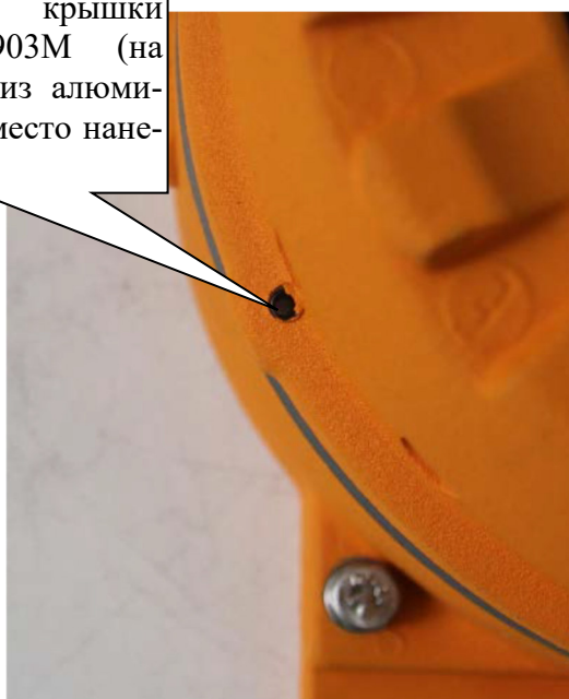
Рисунок 2 - Схема пломбировки газоанализаторов от несанкционированного доступа
