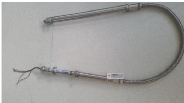
Рисунок 3 – многоточечный термопреобразователь сопротивления 765 с датчиком уровня
