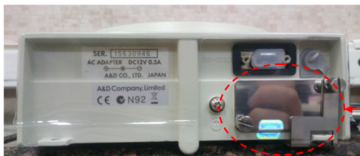
Рисунок 2 - Схема пломбировки весов от несанкционированного доступа
