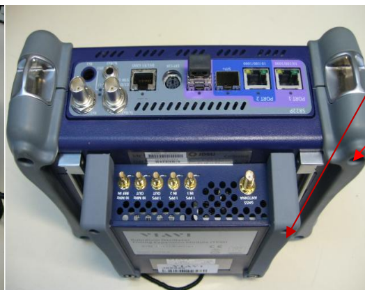
Вид сверху с присоединённым модулем TEM
