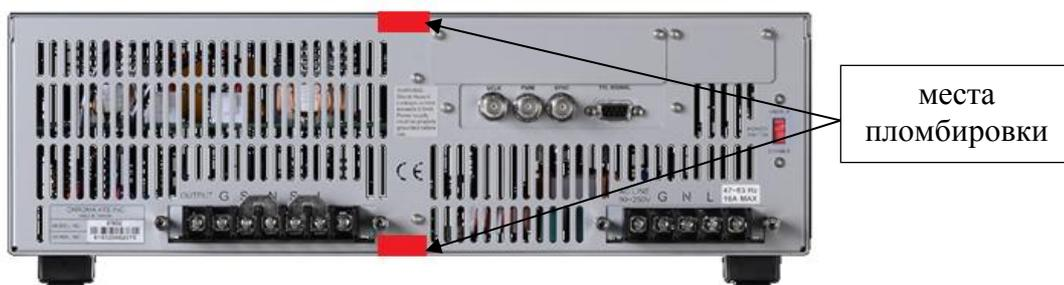
Рисунок 5 - Схема пломбировки от несанкционированного доступа
