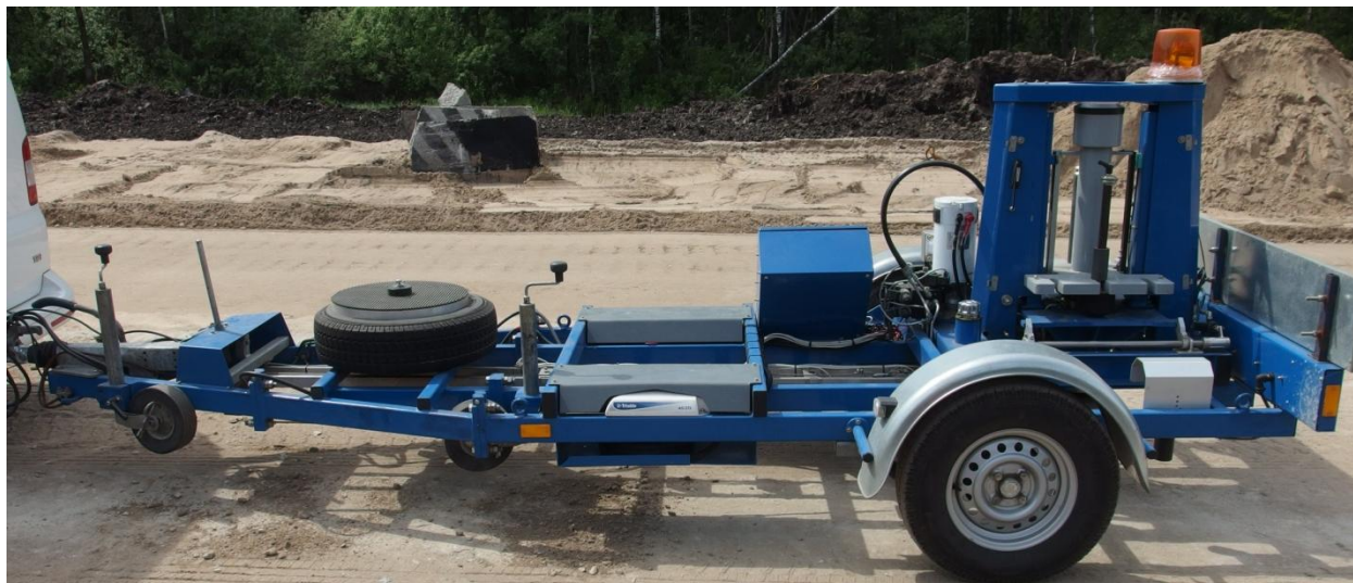
Рисунок 1 Общий вид установки динамического нагружения Dynatest
