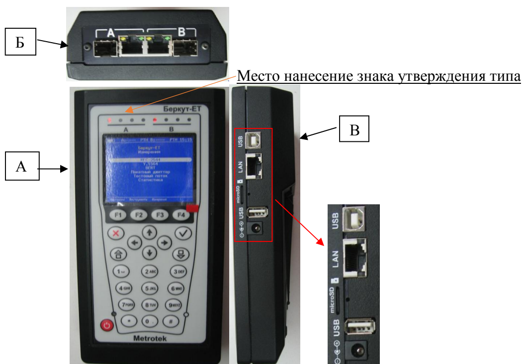
Рисунок 1 - Внешний вид передней панели А, верхней торцевой панели Б и боковой торцевой панели В тестеров-анализаторов серии ЕТ
