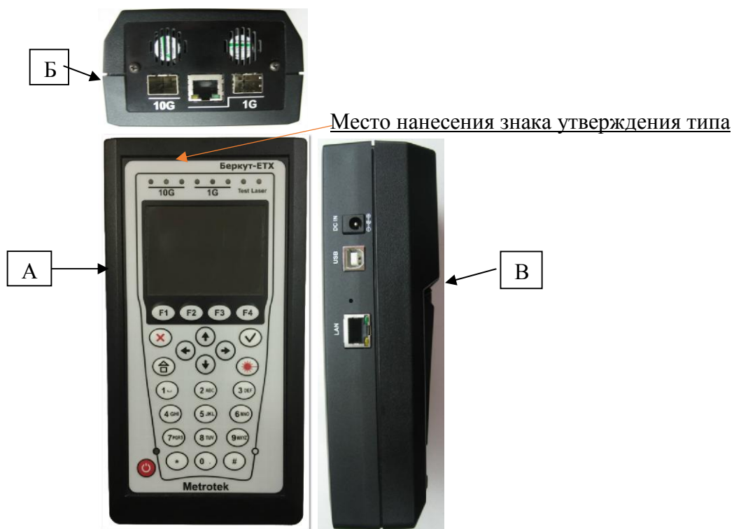
Рисунок 2 - Внешний вид передней панели А, верхней торцевой панели Б и боковой торцевой панели В тестеров-анализаторов серии ETX
