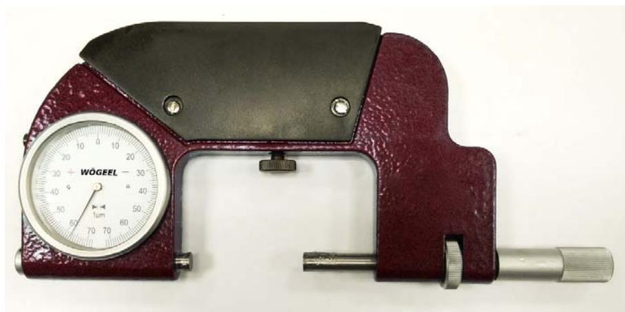
Рисунок 2 - Общий вид скобы рычажной СР-50, СР-75
