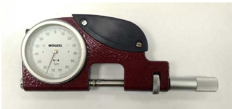
Рисунок 1 - Общий вид скобы рычажной СР-25
