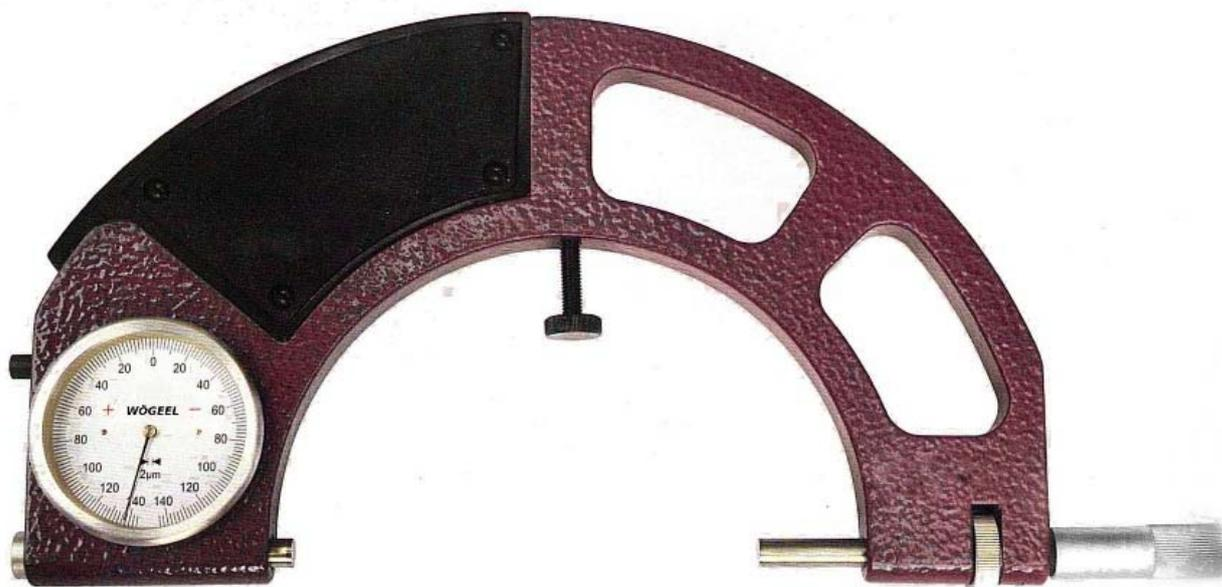
Рисунок 3 - Общий вид скобы рычажной СР-100, СР-125, СР-150
