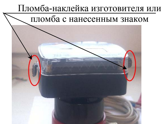
ж) схема пломбировки вычислителя Mono CM-1
