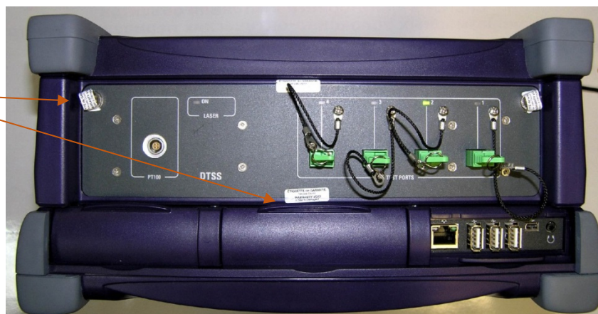
Рисунок 2 - Схема пломбировки от несанкционированного доступа, обозначение места нанесения знака поверки и маркировки
