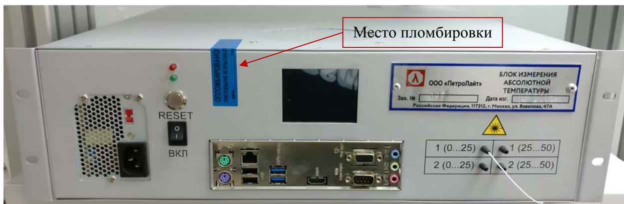
Рисунок 1 - Общий вид блока опроса БИАТ (лицевая сторона)
